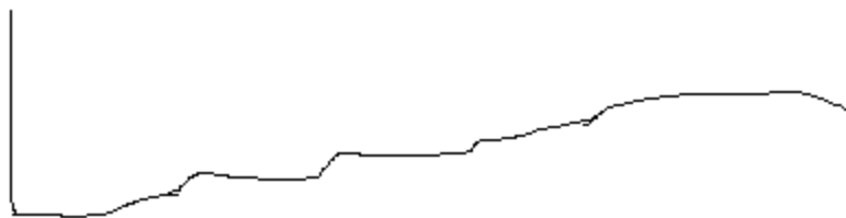
图 6.5-4 冲闪没有放电波形
